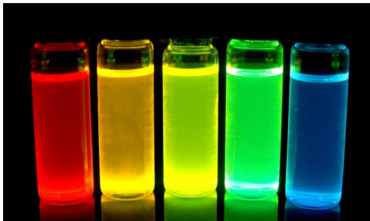
Figura 14. Imagen de fotoluminiscencia de la solución de puntos cuánticos núcleo-coraza de InP/ZnS bajo una lámpara de UV. Estas muestras tienen emisión en longitudes de onda que van del rojo al azul, con un rendimiento cuántico elevado (~60%) en hexano. [15]
